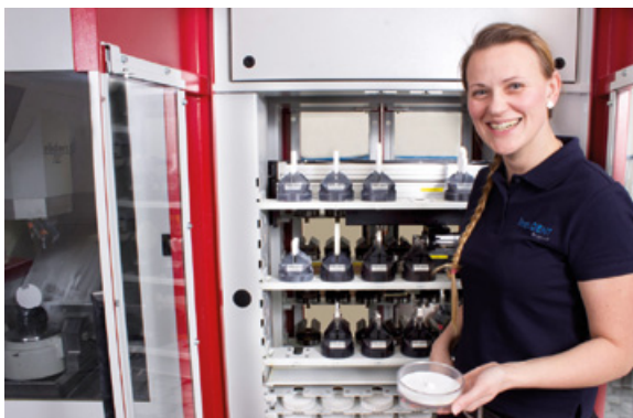
Abb. 9: Entnahme der Schalen mit Fräserzeugnissen aus dem Werkstückmagazin.
